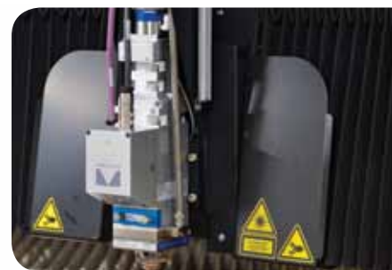
Snijkop met gemotoriseerde focus lens
